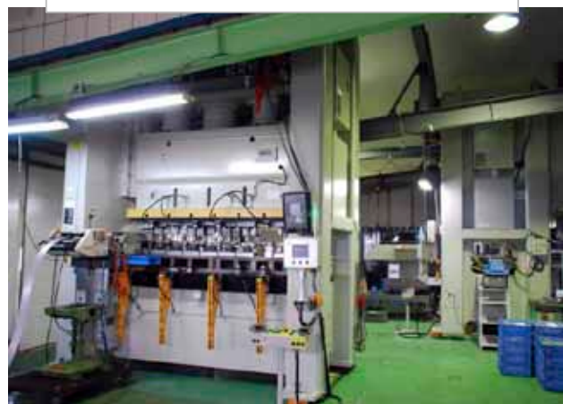
門型250~300トンプレス 4台 ロボット搬送
